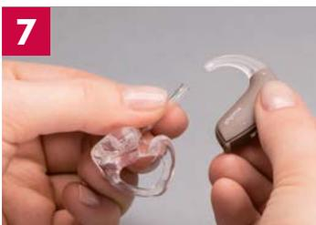
7 Wenn das Ohrstück und der Schallschlauch vollständig trocken sind, mit dem Hörgerät verbinden.
