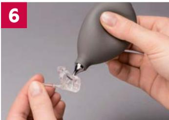
6 Ohrstück mit Papiertaschentuch gut abtrocknen, restliches Wasser mit der Pumpe aus dem Schallschlauch und eventuell der Belüftungsbohrung pusten.
