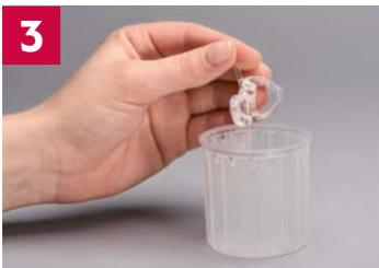
Ohrstück in den Siebeinsatz legen, dann zusammen in den Reinigungsbecher geben. Das Hörgerät selbst darf nicht nass werden.
