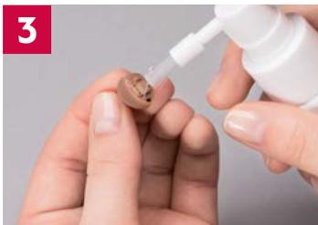
Vertiefungen der Oberfläche vorsichtig mit der kleinen Bürste reinigen. Nicht in Mikrofon- oder Hörer-Öffnungen spritzen.
