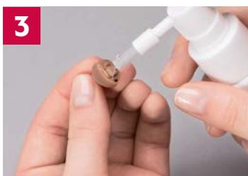
3 Pulite attentamente le irregolarità della superficie con la spazzolina. Non spruzzate lo spray nei fori del microfono o del ricevitore.
