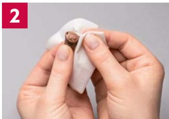
2 Strofinare bene l'apparecchio acustico con il panno umido e rimuovete i residui.
